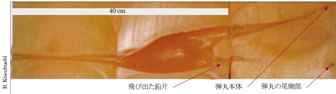
写真 3.16 第 2 段階の、一時的に形成された空洞で断片化した完全被甲弾の射撃溝
