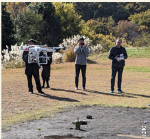
サーモカメラ搭載のドローンを飛ばして爆発物を探知するためのテスト（2019 年）
